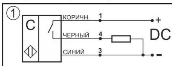
Схема соединения Нормально-разомкнутый контакт
