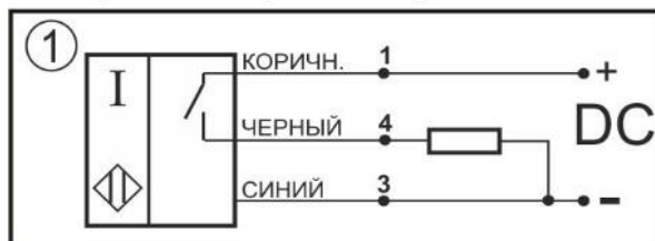
Схема соединения Нормально-разомкнутый контакт
