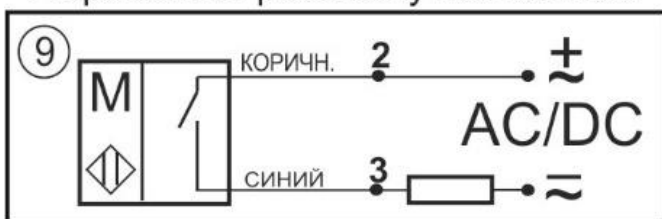
Схема соединения Нормально-разомкнутый контакт
