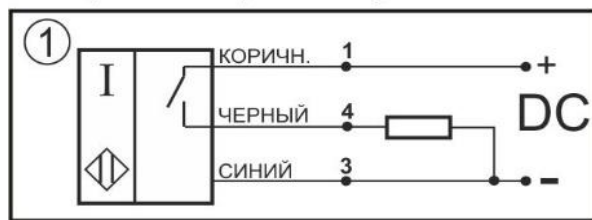
Схема соединения Нормально-разомкнутый контакт
